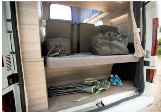
La soute arrière présente un double niveau pour exploiter toute la hauteur du véhicule et optimiser ainsi l'espace de chargement.
